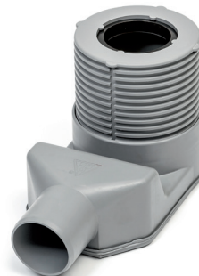
Поворотный сифон на 360 с регулировкой высоты и боковым сливом D 50 гидрозатвор
